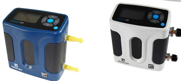
Mesa (BIOS) 流量计采用干式无油 DryCal 技术，符合 ISO 17025 标准。用快速启动键，立即开始校准，不用复杂的准备，不用肥皂沫，你所要做的仅是选择 510, 520, 530 或者 220 系列。有着广泛的应用，例如：空气采样泵、呼吸机设备、环境监测仪器等设备的制造过程中的质量控制。部分型号提供温度和压力补偿，温度和压力传感器集成在流体上，这样用户可自动将体积流量转换成标态下的读数，用于验证质量流量测量设备。
